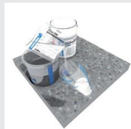
4. Za pomocą kubka ze skalą ALSAN odmierzyć odpowiednią ilość katalizatora zgodnie z kartą produktu.
